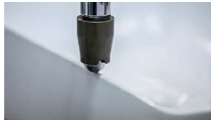
ТЕСТИРОВАНИЕ КРАЕВОЙ ПРОЧНОСТИ УЛЬТРАТОНКИХ СТенок ИЗДЕЛИЙ ИЗ МАТЕРИАЛА SAPHIRKERAMIK (KERAMIK INSTITUT MEISSEN)
