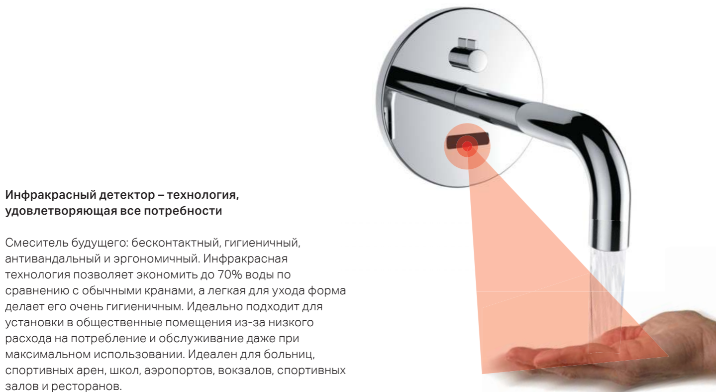
Подача воды начинается, как только ваши руки попадают в зону обнаружения.
