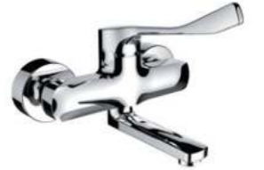
LIBERTY PRO Настенный смеситель «liberty», проекция 175 / 225 мм, поворотный излив, длина 134-166 мм, картридж с ограничением напора
